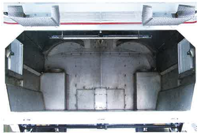
La benne, d'un volume brut de 6,2 m 3 , est constituée d'acier inoxydable résistant aux abrasions et de trappes de chargement latéral des deux côtés.
