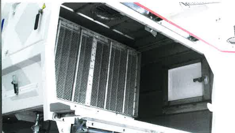
Filtre à particules à mailles en acier inoxydable, articulé et plissé, pour offrir la surface maximale et réduire l'encrassement – rabattable vers le bas pour faciliter le nettoyage.
