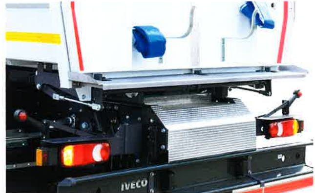
Système de blocage de la porte arrière à trois points pour garantir une parfaite étanchéité et la goulotte de décharge.
