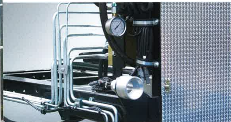
Le système hydraulique comprend de nombreuses tuyauteries en acier, afin de minimiser l'utilisation de tuyaux flexibles.
